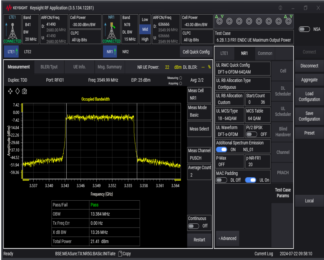
n78 SCS=30kHz DFT_QAM64 BW=20MHz Channel=636666 RB=50@0
