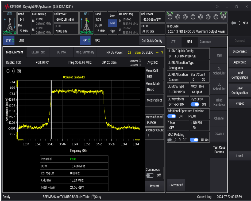
n78 SCS=30kHz DFT_BPSK BW=20MHz Channel=636666 RB=50@0
