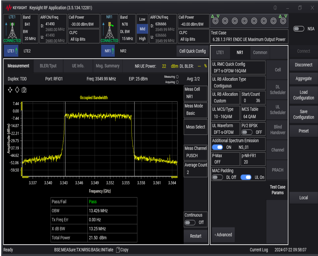
n78 SCS=30kHz DFT_QAM16 BW=20MHz Channel=636666 RB=50@0
