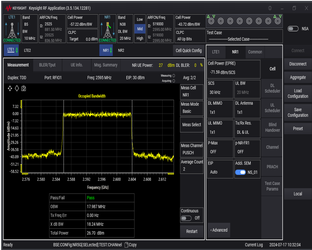
n38 SCS=30kHz DFT_QPSK BW=20MHz Channel=519000 RB=50@0
