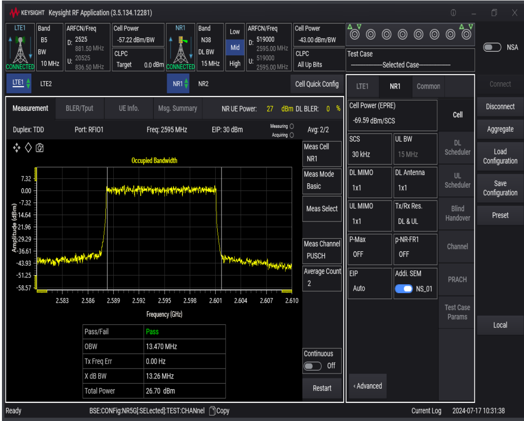
n38 SCS=30kHz DFT_QPSK BW=20MHz Channel=519000 RB=50@0
