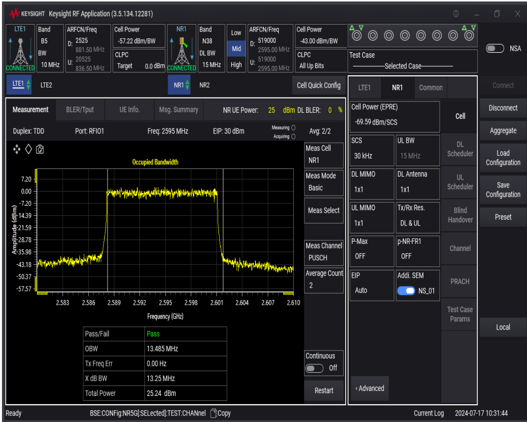
n38 SCS=30kHz DFT_QAM64 BW=20MHz Channel=519000 RB=50@0
