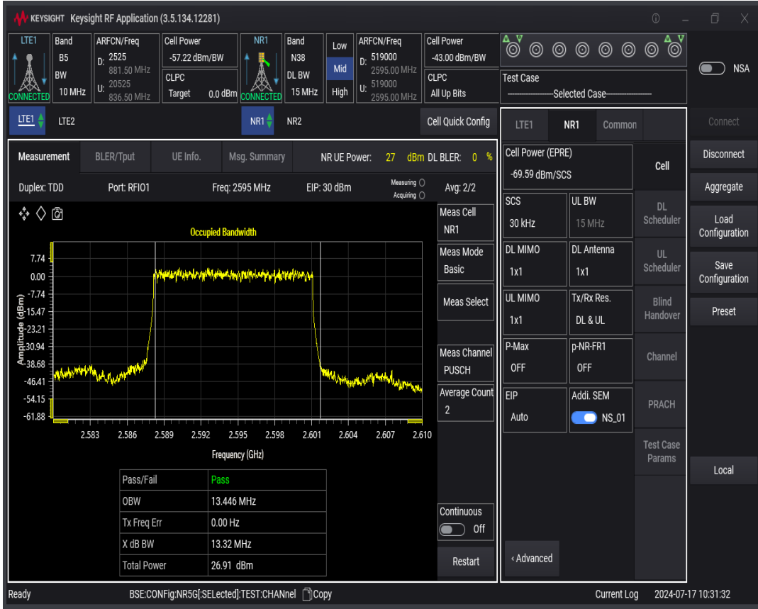
n38 SCS=30kHz DFT_BPSK BW=20MHz Channel=519000 RB=50@0
