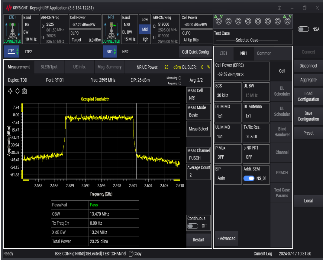
n38 SCS=30kHz DFT_QAM256 BW=20MHz Channel=519000 RB=50 @0
