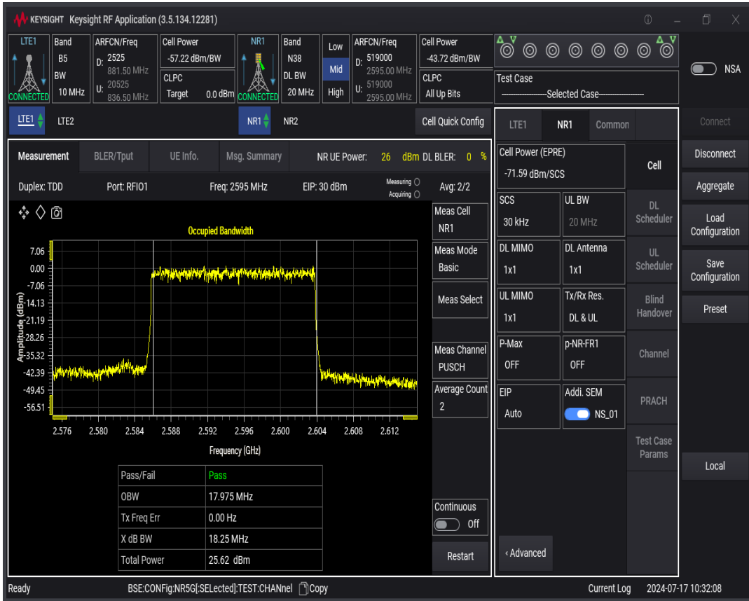
n38 SCS=30kHz DFT_QAM256 BW=10MHz Channel=519000 RB=24@0
