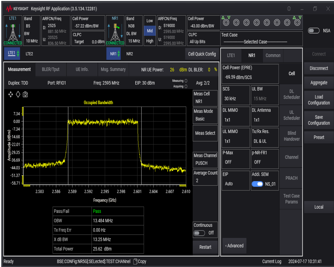
n38 SCS=30kHz DFT_QAM16 BW=20MHz Channel=519000 RB=50@0
