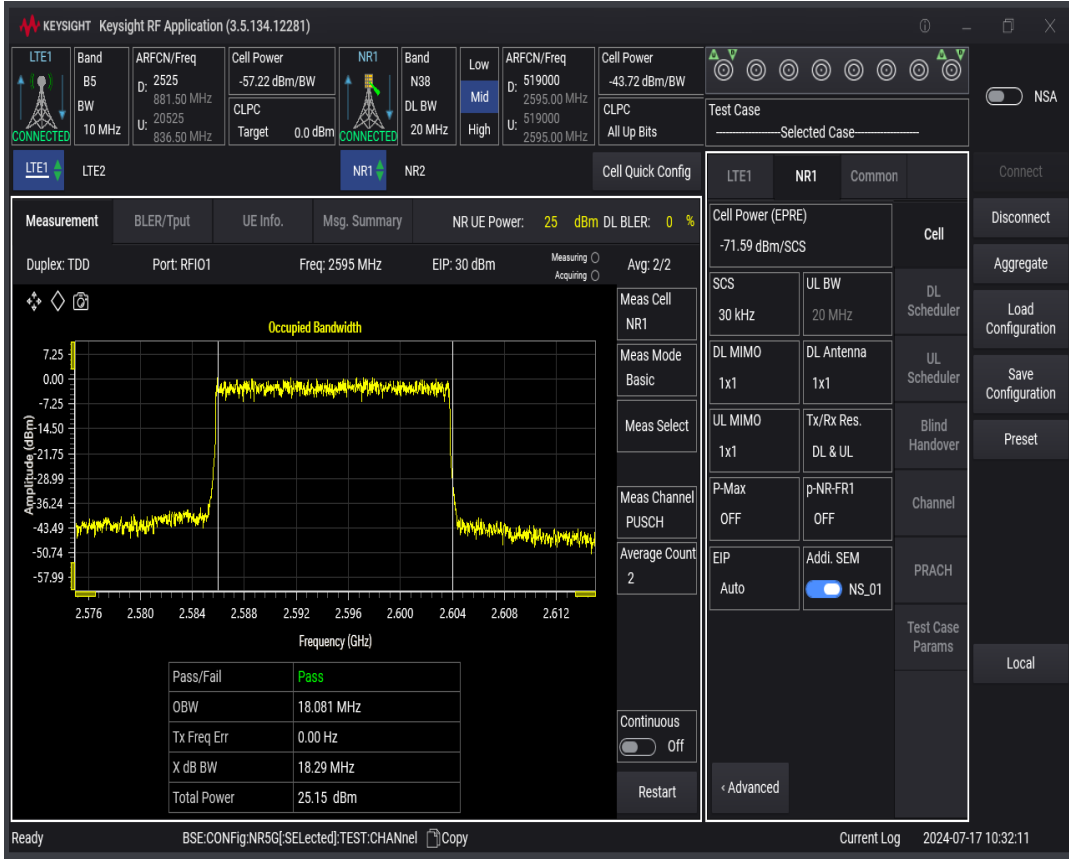
n38 SCS=30kHz DFT_QPSK BW=10MHz Channel=519000 RB=24 @0
