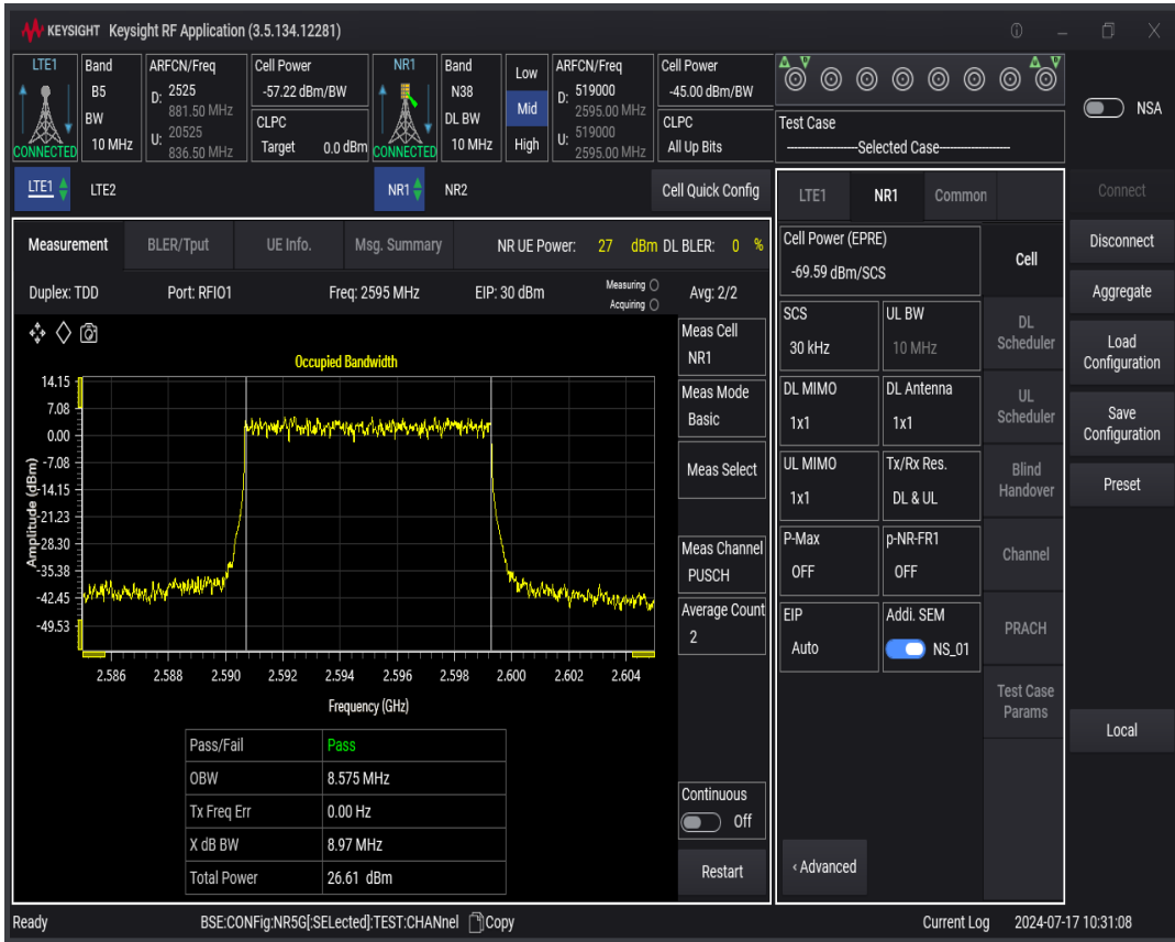
n38 SCS=30kHz DFT_QPSK BW=15MHz Channel=519000 RB=36 @0
