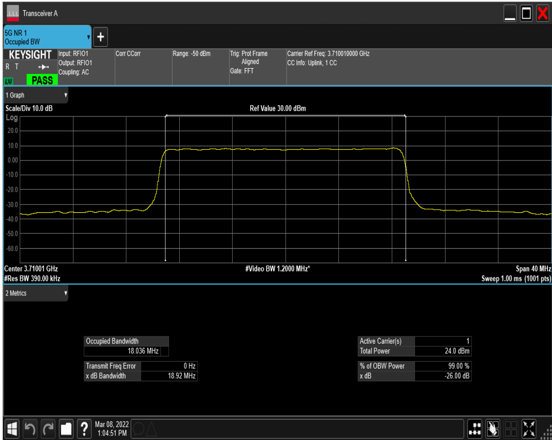
n77(3700-3980) SCS=30kHz DFT_QAM16 BW=20MHz Channel=647334 RB=50@0
