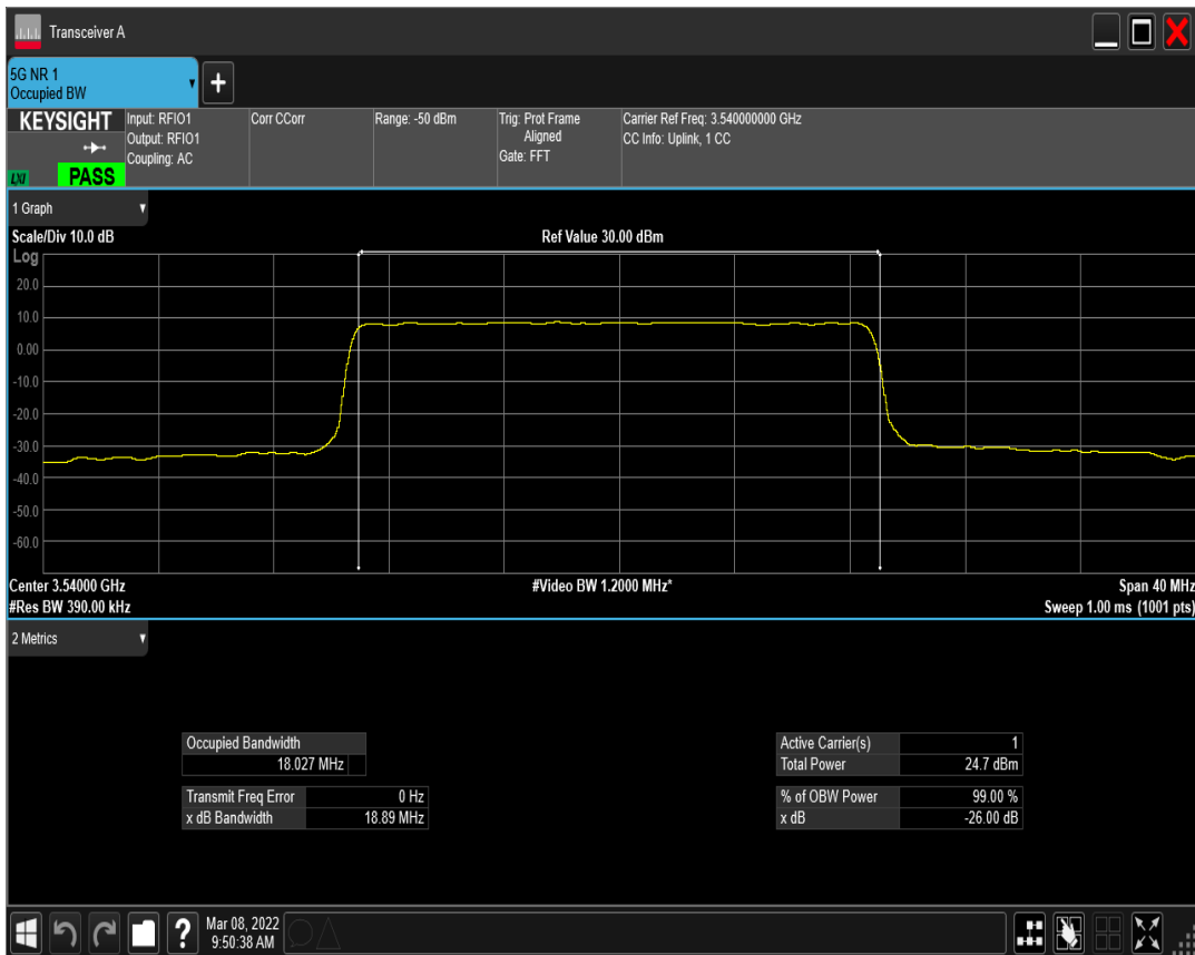
n77(3450-3550) SCS=30kHz DFT_QPSK BW=20MHz Channel=636000 RB=50@0
