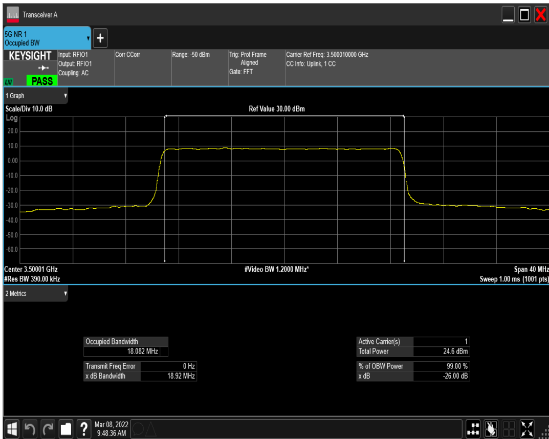
n77(3450-3550) SCS=30kHz DFT_QPSK BW=20MHz Channel=633334 RB=50@0
