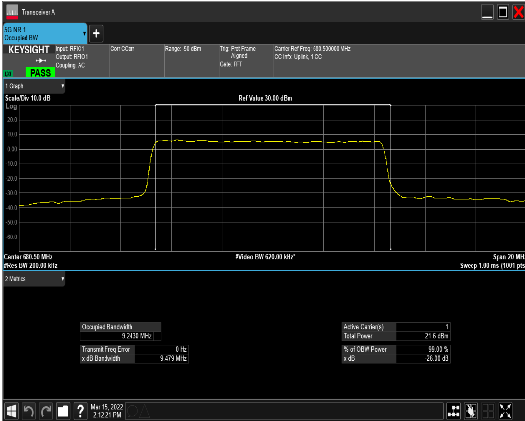
n71 SCS=15kHz DFT_QAM16 BW=10MHz Channel=136100 RB=50@0
