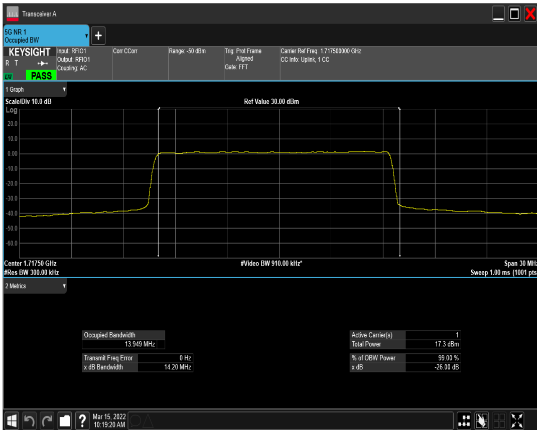
n66 SCS=15kHz DFT_QAM256 BW=15MHz Channel=343500 RB=75@0
