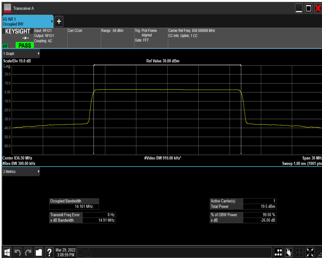
n5 SCS=15kHz CP_QPSK BW=15MHz Channel=167300 RB=79@0
