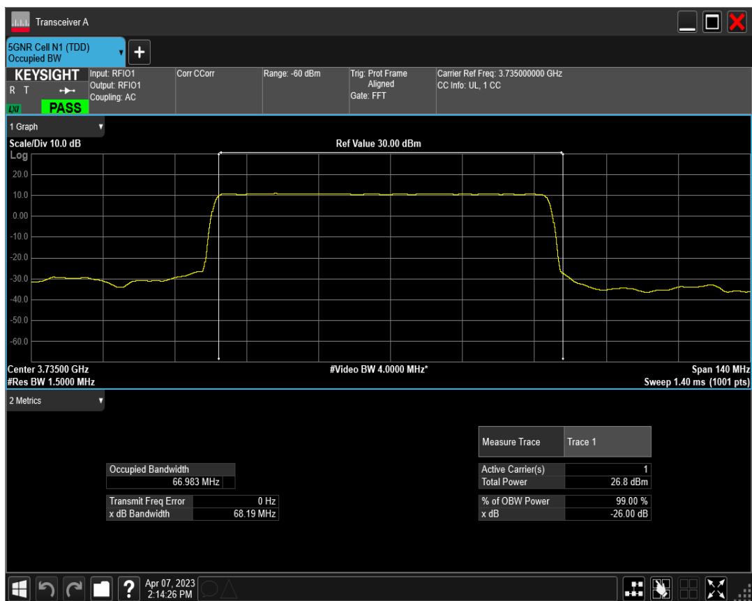
n78(3700-3800) SCS=30kHz DFT_QPSK BW=70MHz Channel=649000 RB=180@0
