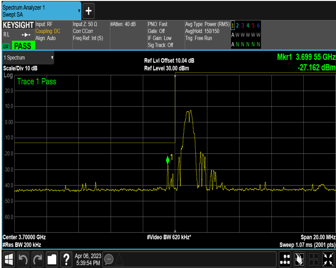
n77(3700-3980) SCS=30kHz DFT_QPSK BW=10MHz Channel=665000 RB=24@0
