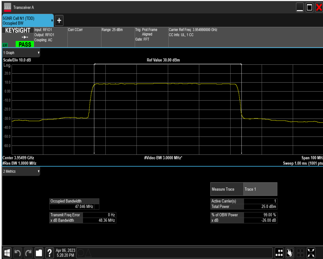
n77(3700-3980) SCS=30kHz DFT_QAM256 BW=50MHz Channel=663666 RB=128@0
