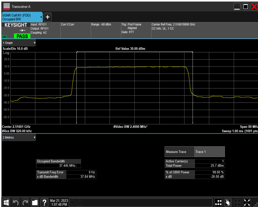
n41 SCS=30kHz DFT_QPSK BW=40MHz Channel=503202 RB=100@0
