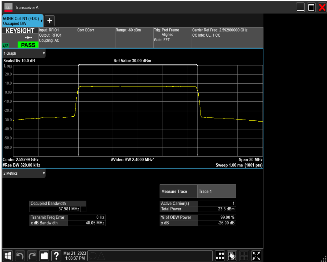
n41 SCS=30kHz DFT_BPSK BW=40MHz Channel=534000 RB=100@0
