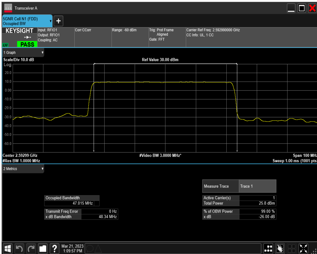
n41 SCS=30kHz DFT_QPSK BW=50MHz Channel=518598 RB=128@0
