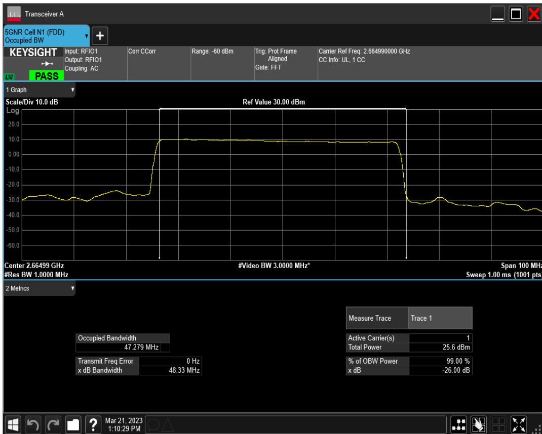
n41 SCS=30kHz DFT_QPSK BW=50MHz Channel=532998 RB=128@0
