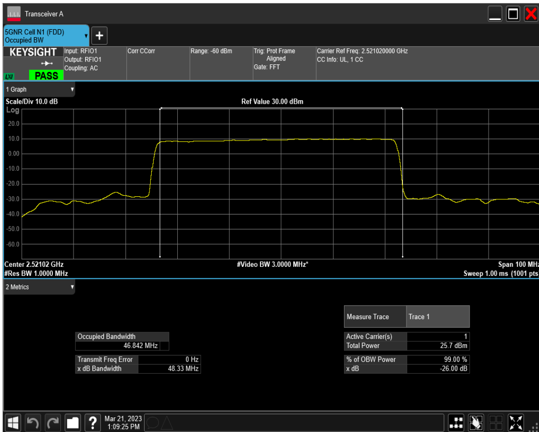
n41 SCS=30kHz DFT_QPSK BW=50MHz Channel=504204 RB=128@0
