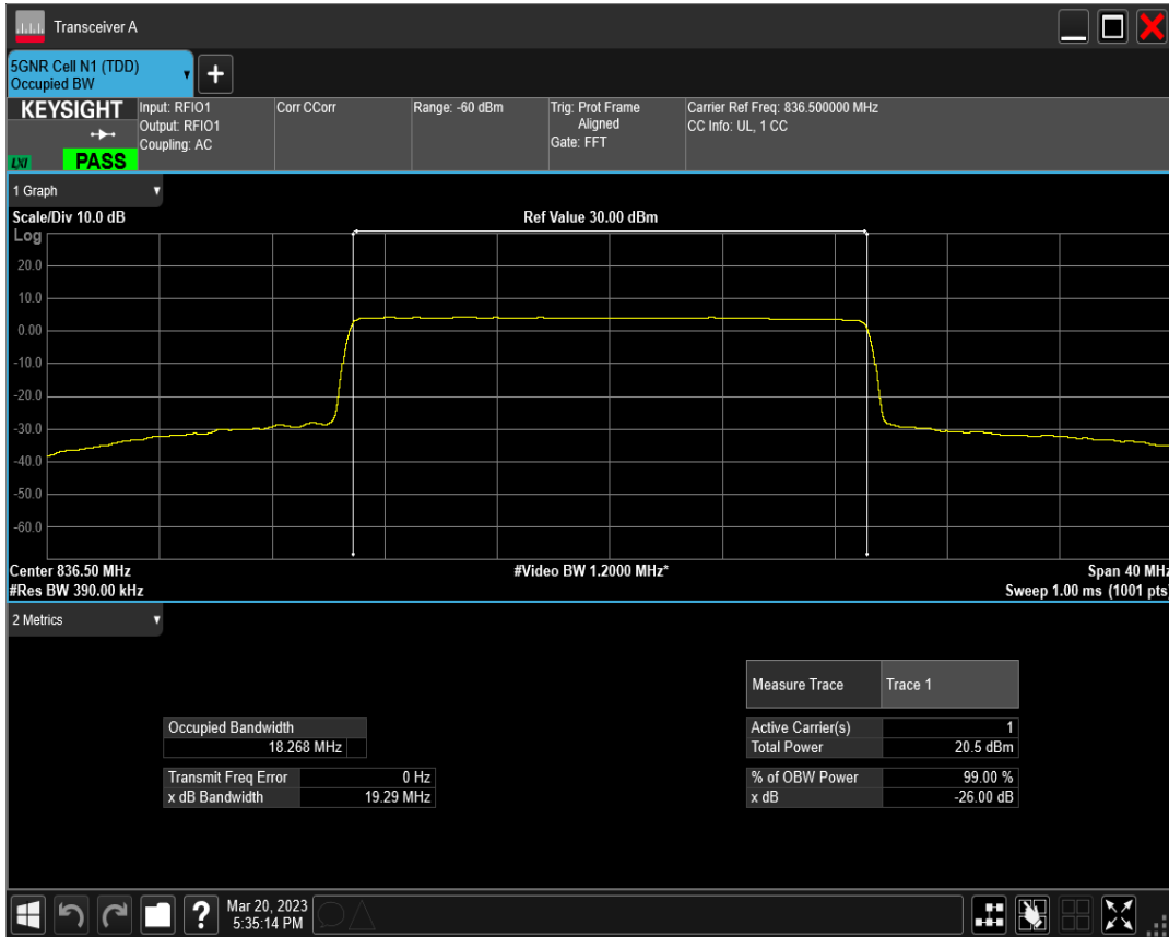
n5 SCS=30kHz DFT_BPSK BW=20MHz Channel=167800 RB=50@0
