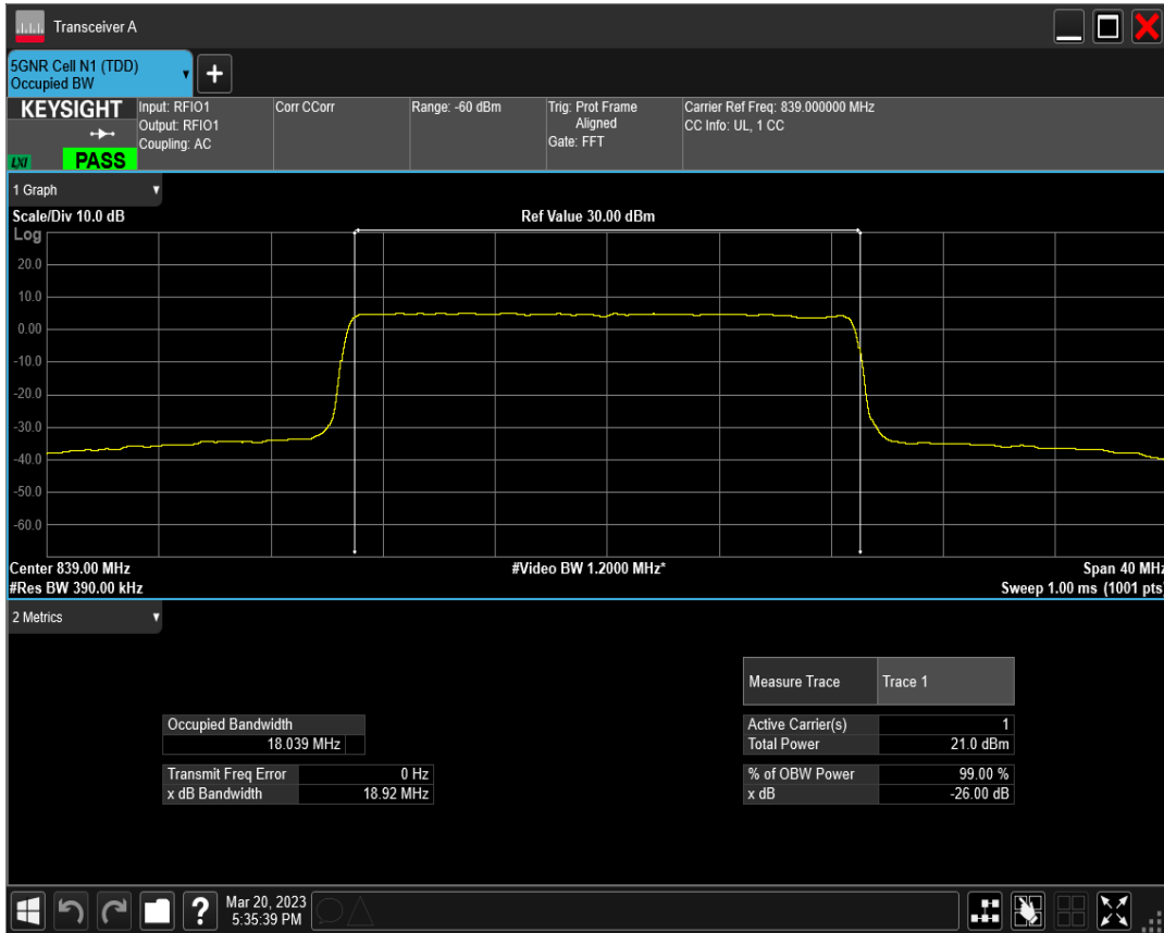
n5 SCS=30kHz DFT_QAM256 BW=20MHz Channel=167800 RB=50@0
