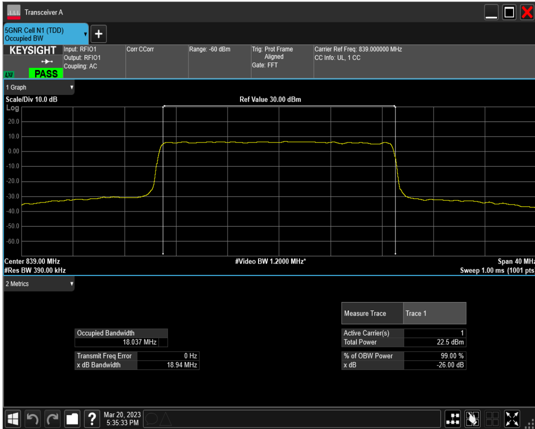
n5 SCS=30kHz DFT_QAM16 BW=20MHz Channel=167800 RB=50@0
