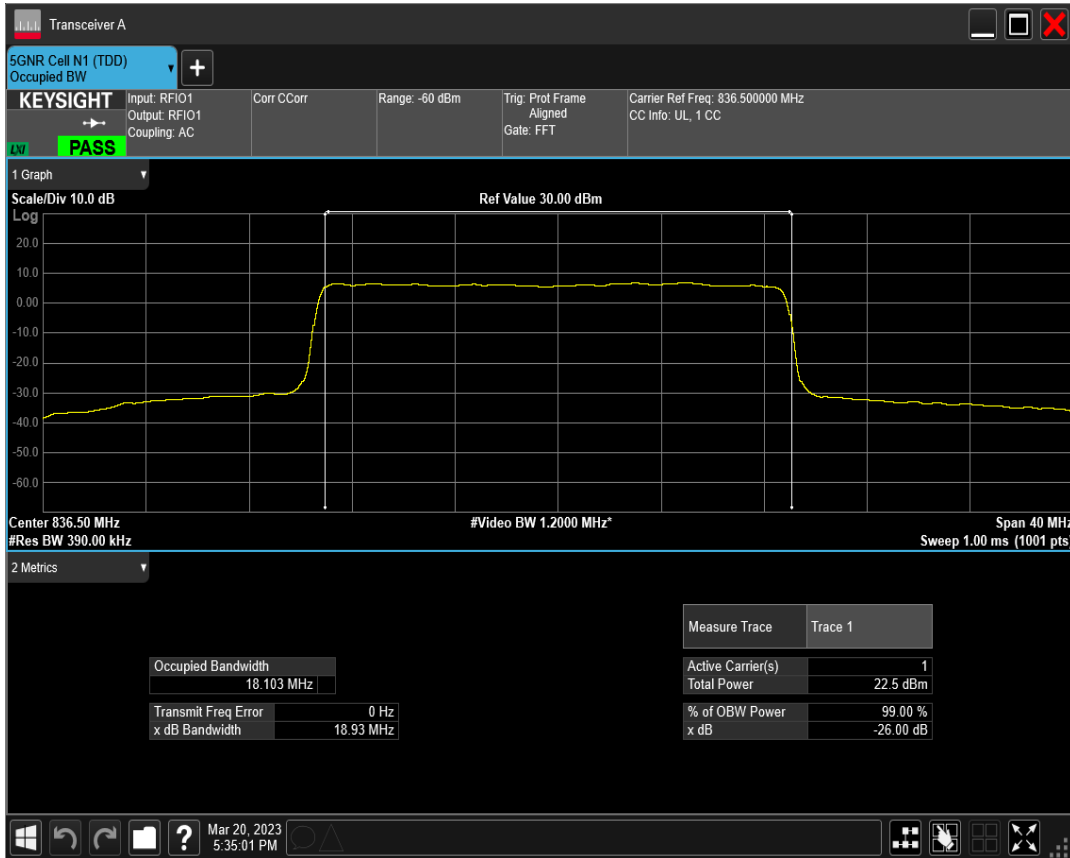
n5 SCS=30kHz DFT_QAM16 BW=20MHz Channel=167300 RB=50@0
