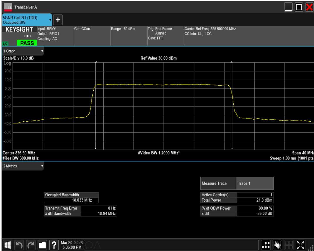
n5 SCS=30kHz DFT_QAM256 BW=20MHz Channel=167300 RB=50@0
