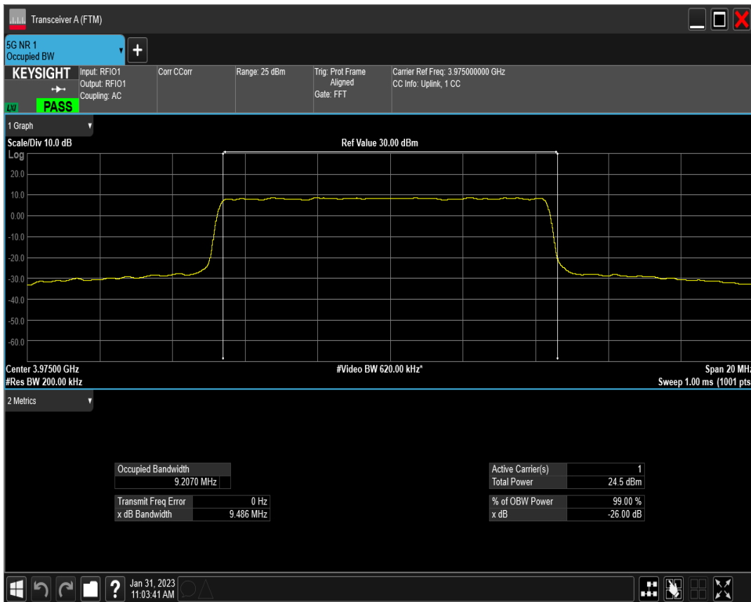
n77(3700-3980) SCS=15kHz DFT_QAM256 BW=10MHz Channel=665000 RB=50@0
