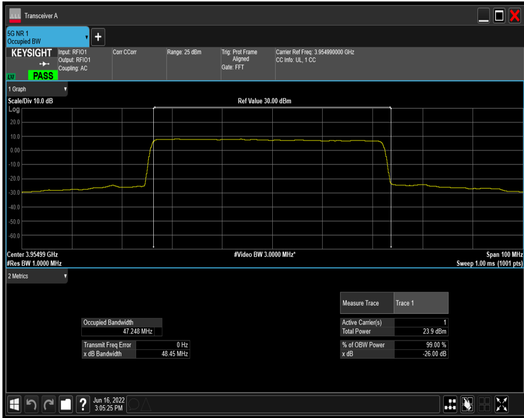
n77(3700-3980) SCS=30kHz DFT_QAM256 BW=50MHz Channel=663666 RB=128@0
