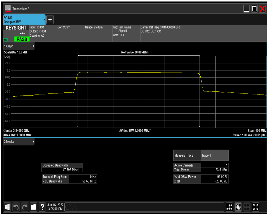
n77(3700-3980) SCS=30kHz DFT_BPSK BW=50MHz Channel=663666 RB=128@0
