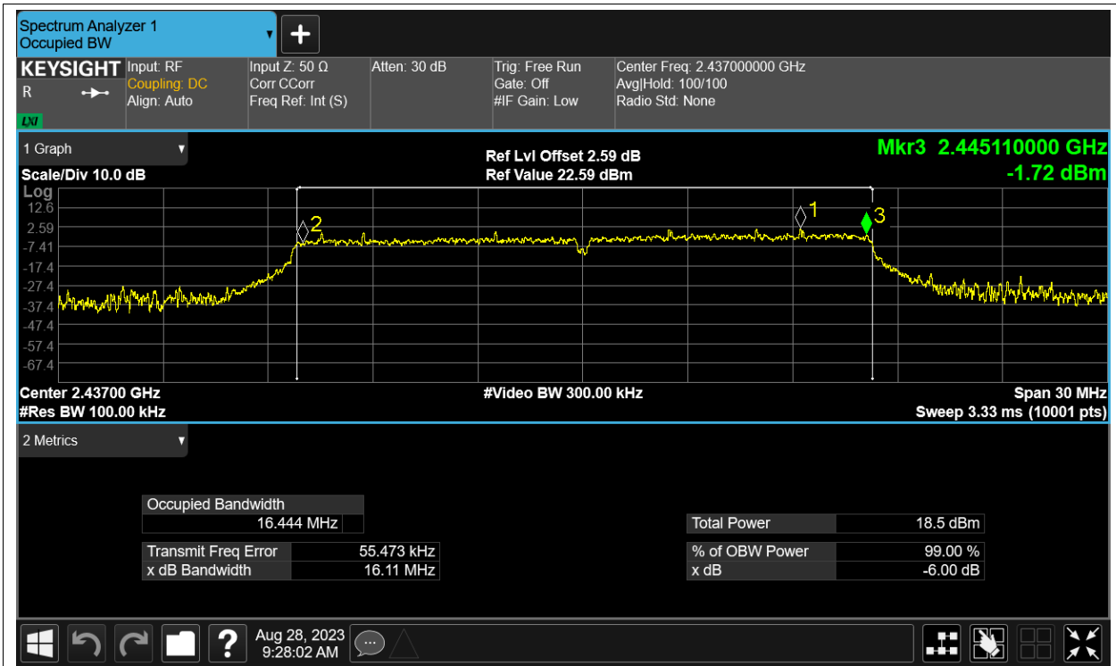
-6dB Bandwidth NVNT g 2462MHz Ant1
