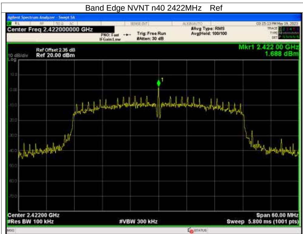
Band Edge NVNT n40 2422MHz Emission
