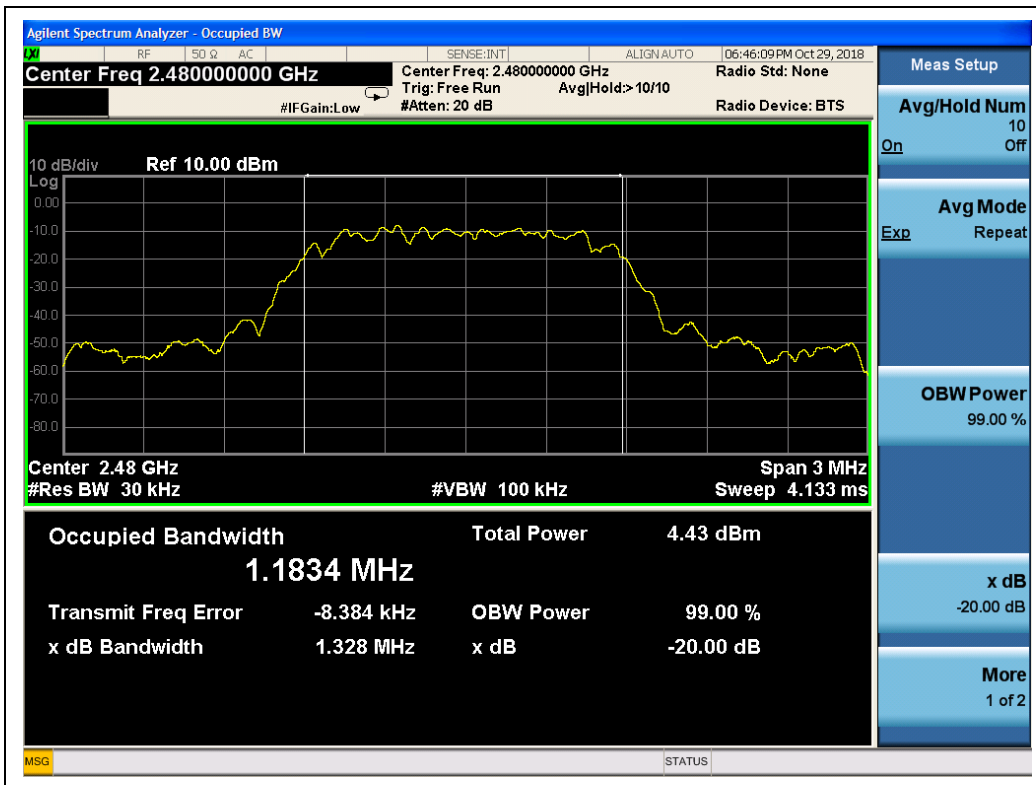
( \pi/4 -DQPSK, Channel 78, 2480MHz)
