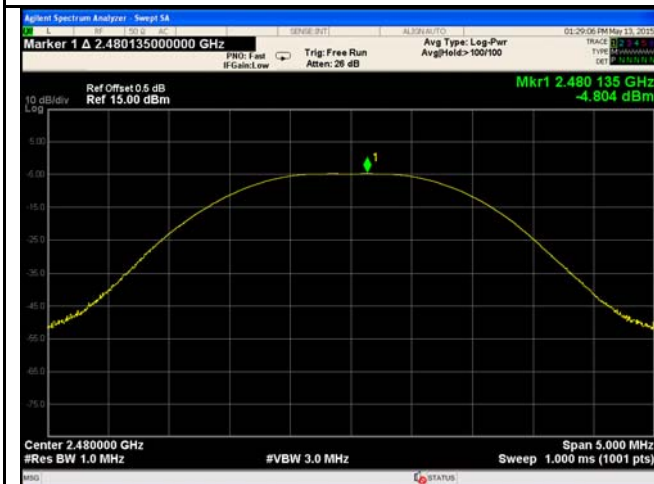
AV Output power - High CH 2480
