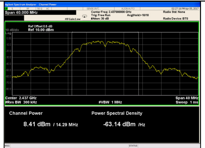
802.11b - AV Output power - Mid CH 2437
