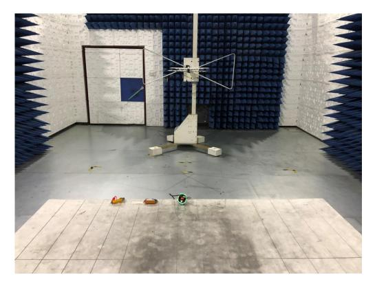
**RADIATED EMISSION TEST SETUP Above 1G**
