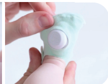
El calcetín 2, 3 y 4 siempre debe colocarse con el sistema electrónico del calcetín en la parte superior del pie izquierdo.
