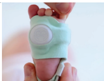
Les pièces électroniques de la chaussette pour nouveau-né de taille 1 doivent toujours être placées sur la plante du pied.
