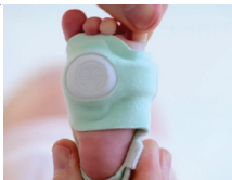
El calcetín talla 1 para recién nacido siempre debe colocarse con el sistema electrónico del calcetín en la planta del pie.
