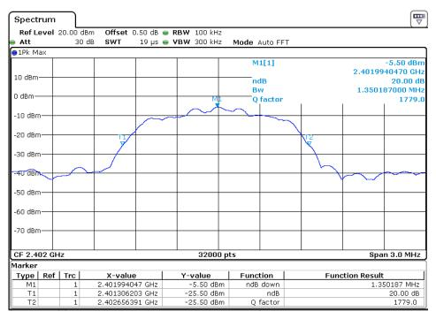
Modulation Standard:  $\pi/4$  DQPSK
