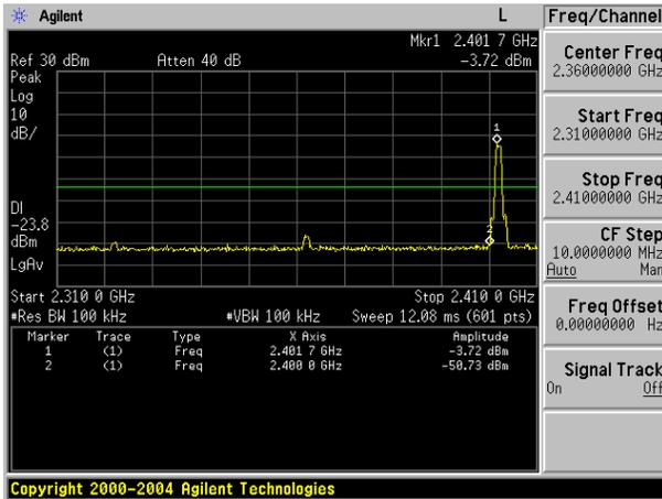
BDR mode ( $\pi/4$ -DQPSK): Band Edge-High Channel
