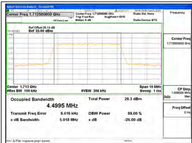
Band4 / 5MHz / QPSK/ Low CH
