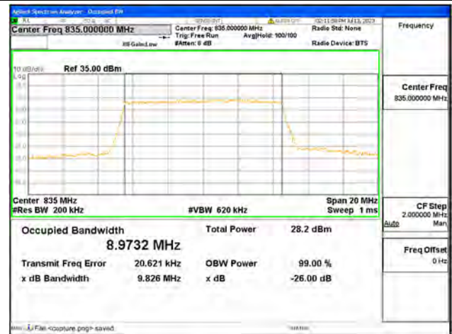
Band19 / 10MHz / QPSK/ Low CH
