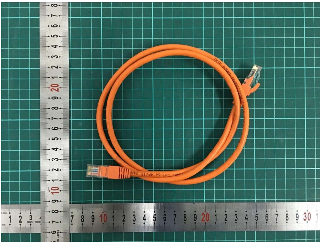
c : Ethernet cables
