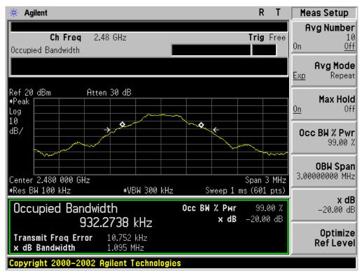
TEST PLOT OF BANDWIDTH FOR HIGH CHANNEL
