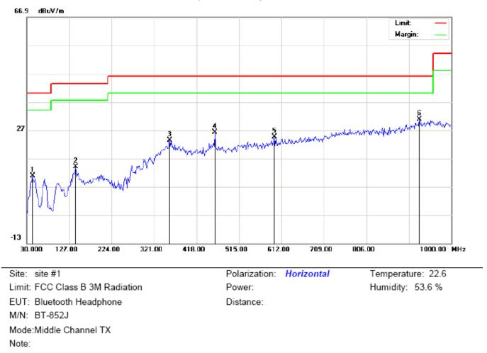
RADIATED EMISSION TEST- (30MHz-1GHz)-MIDDLE CHANNEL-HORIZONTAL
