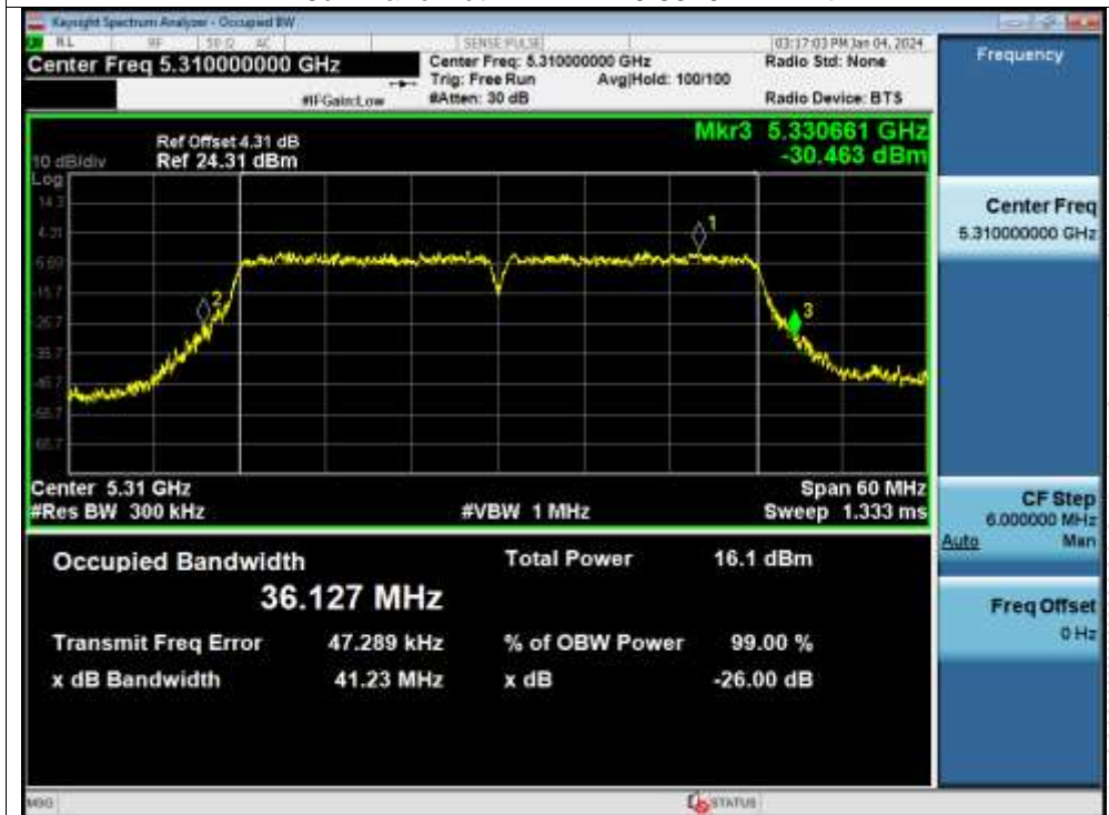
-26dB Bandwidth NVNT n40 5310MHz Ant1
