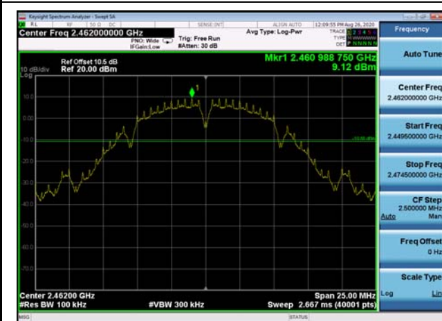
,Plot 2,Band Edge-802.11b,2437MHz
