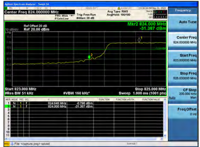
B5 / 5MHz / High CH / QPSK / FULL RB
