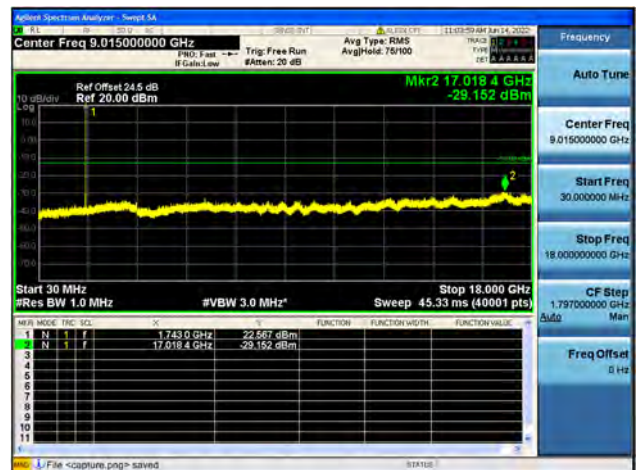
B66 / 5MHz / Mid CH / 64QAM
