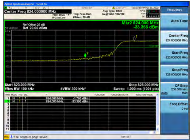
B5 / 10MHz / High CH / QPSK / FULL RB
