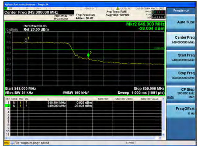
B5 / 5MHz / High CH / QPSK / FULL RB
