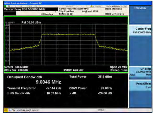
Band26 / 10MHz / High CH / QPSK
