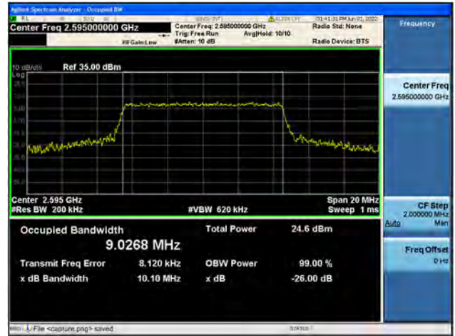
B38 / 10MHz / QPSK/ High CH
