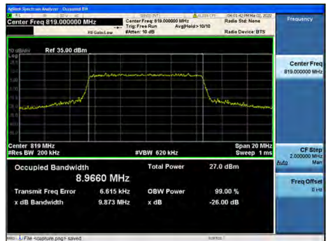
Band26 / 10MHz / Mid CH / 64QAM
