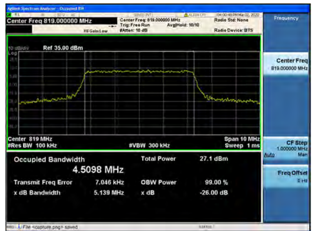
Band26 / 5MHz / Mid CH / 64QAM
