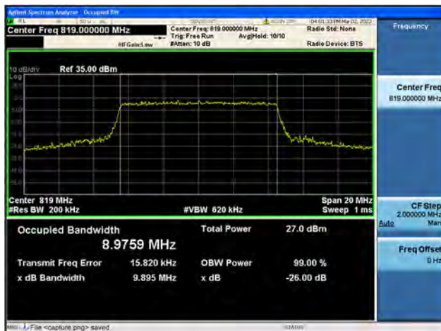
Band26 / 10MHz / Mid CH / 16QAM
