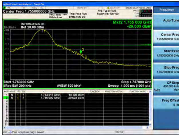
Band4 / 20MHz / High CH / QPSK / 1 RB
