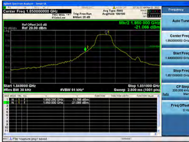
Band2 / 1.4MHz / High CH / QPSK / 1 RB
