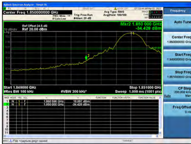
Band2 / 10MHz / High CH / QPSK / 1 RB
