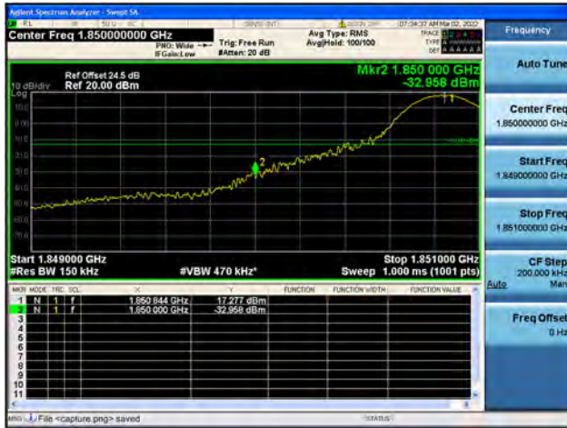
Band2 / 15MHz / High CH / QPSK / 1 RB
