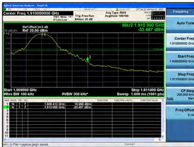
Band2 / 10MHz / High CH / QPSK / 1 RB
