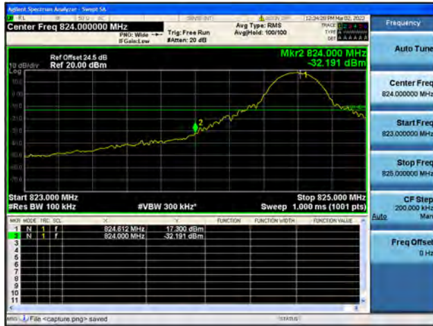
Band5 / 10MHz / High CH / QPSK / 1 RB
