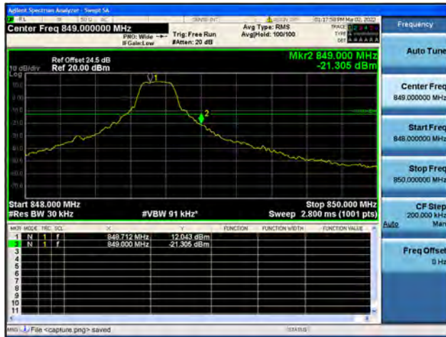
Band26 / 1.4MHz / High CH / QPSK / 1 RB
