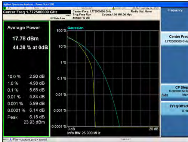
Band66 / 20MHz / Low CH / 16QAM
