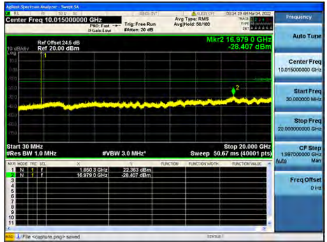
Band2 / 5MHz / Mid CH / QPSK
