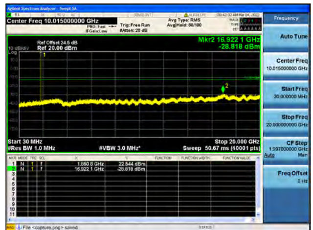
Band2 / 20MHz / Low CH / 64QAM
