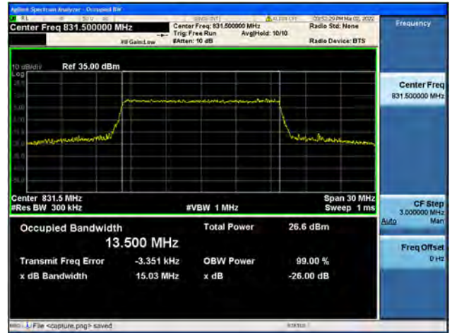
Band26 / 15MHz / Mid CH / QPSK
