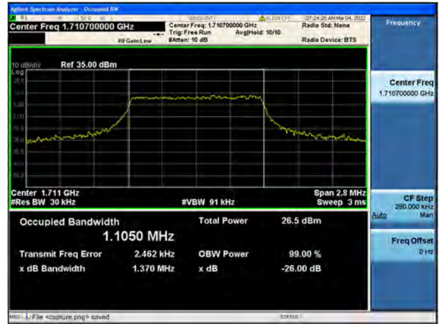
Band66 / 1.4MHz / Mid CH / QPSK
