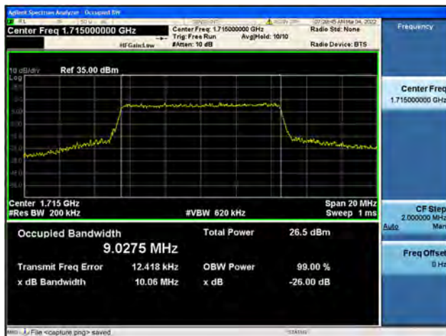
Band66 / 10MHz / Low CH / 16QAM
