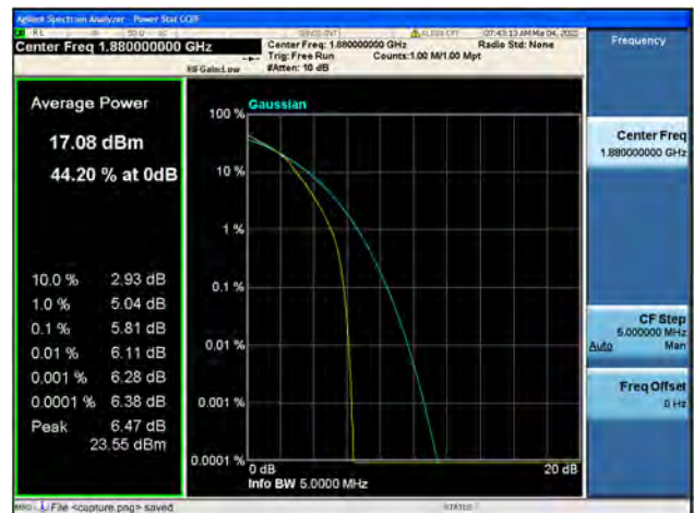
Band2 / 5MHz / Mid CH / 64QAM
