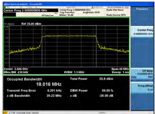
Band41 / 20MHz / Low CH / 64QAM
