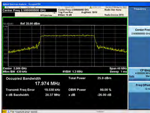
Band41 / 20MHz / Low CH / 16QAM
