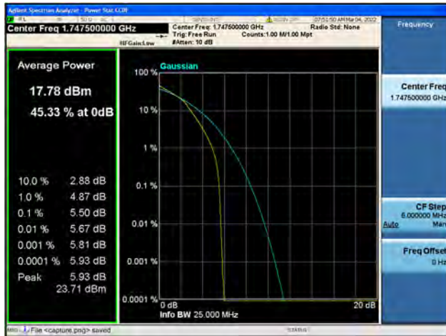
Band4 / 20MHz / Low CH / 16QAM
