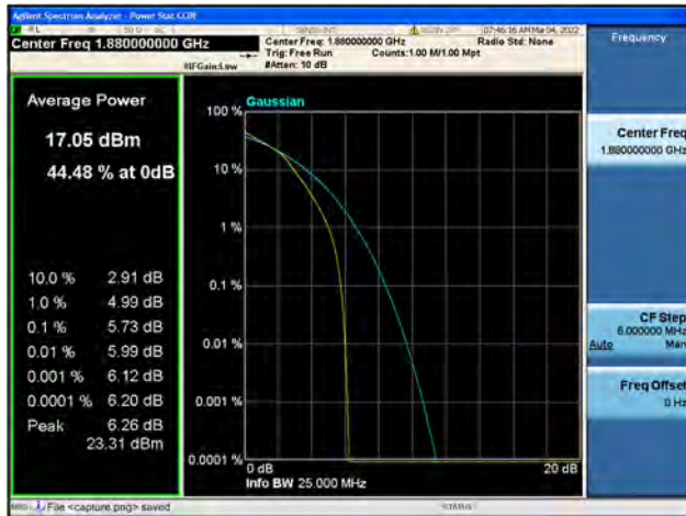
Band2 / 20MHz / High CH / 16QAM
