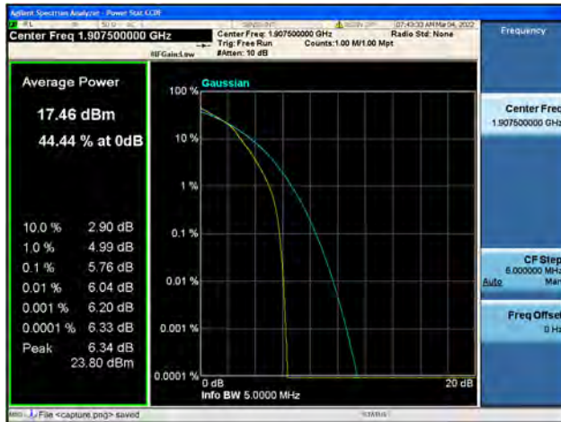
Band2 / 10MHz / Low CH / 16QAM
