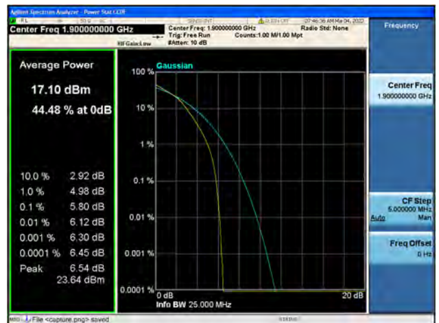
Band2 / 20MHz / High CH / 64QAM
