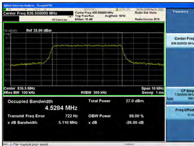
Band26 / 5MHz / Mid CH / 16QAM
