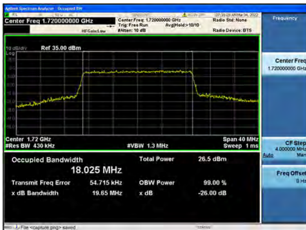
Band66 / 20MHz / Low CH / 16QAM
