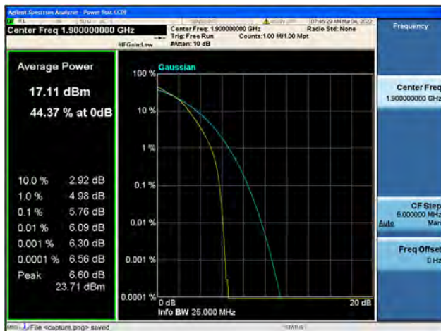
Band2 / 20MHz / High CH / 16QAM
