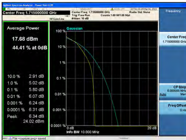
Band66 / 10MHz / Low CH / 16QAM
