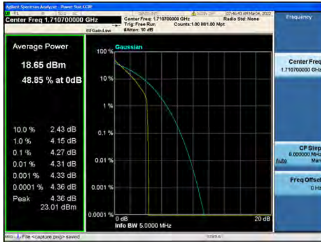
Band4 / 1.4MHz / Low CH / 64QAM
