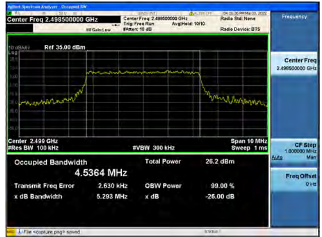
Band41 / 5MHz / Mid CH / QPSK
