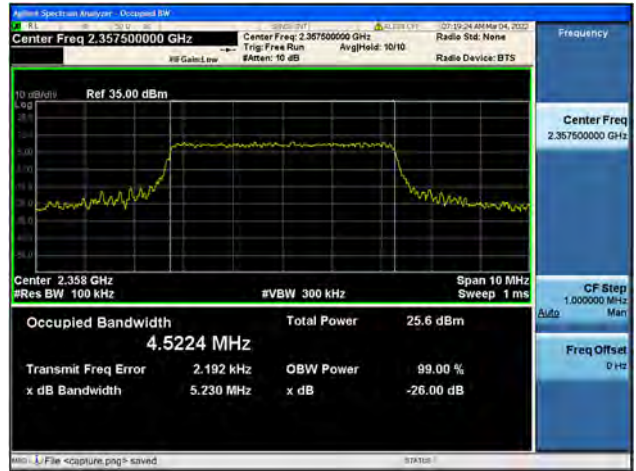
Band40/ Block B / 10MHz / Mid CH / QPSK
