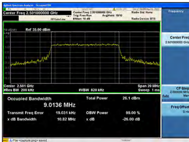
Band41 / 10MHz / Low CH / 16QAM
