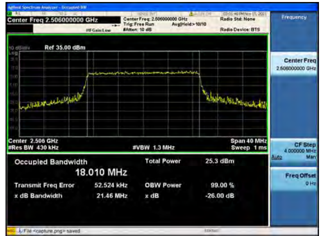
Band41 / 20MHz / Low CH / 64QAM
