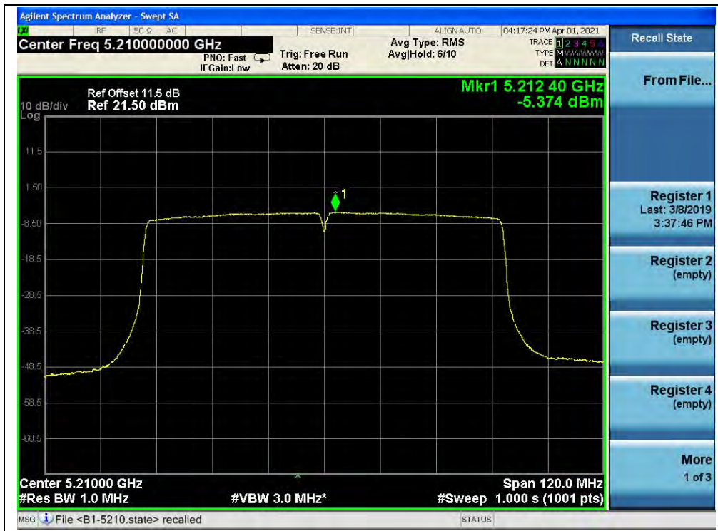
(Channel 42, 5210MHz, 802.11ac (VHT80), ANT0)
