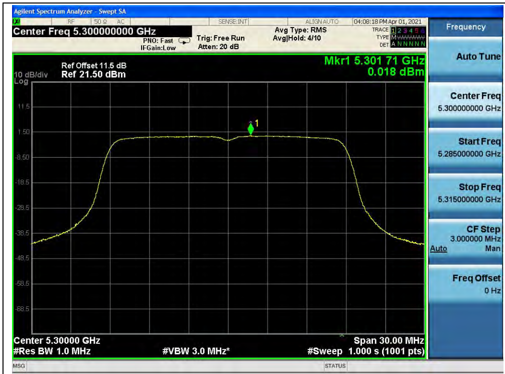
(Channel 60, 5300MHz, 802.11ac (VHT20), ANT0)
