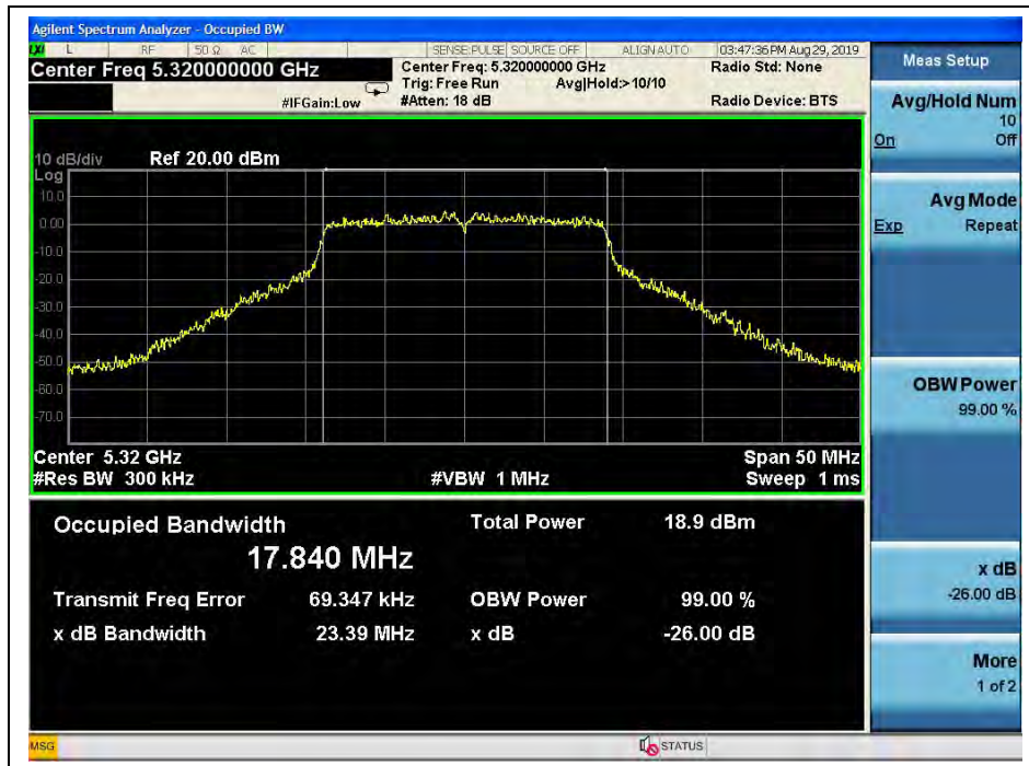
(Channel 64, 5320MHz, 802.11 ac (VHT20))
