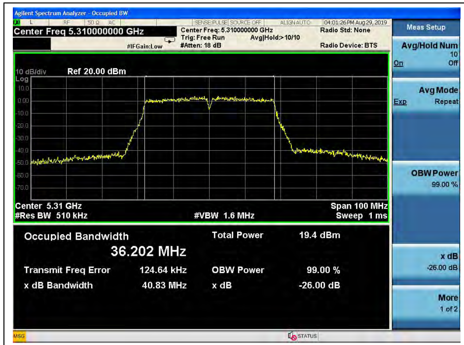
(Channel 62, 5310 MHz, 802.11 ac (VHT40))
