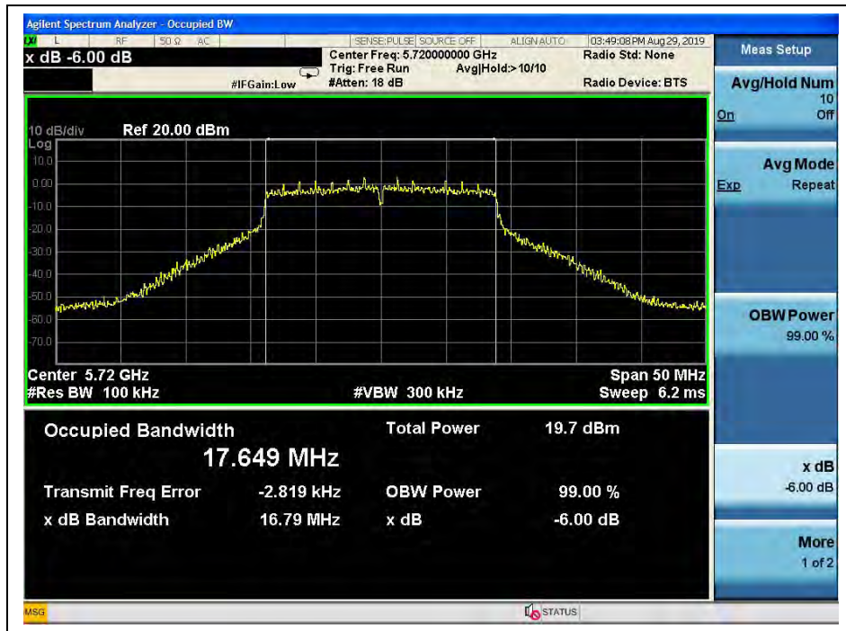
(Channel 144, 5720MHz, 802.11 ac (VHT20))
