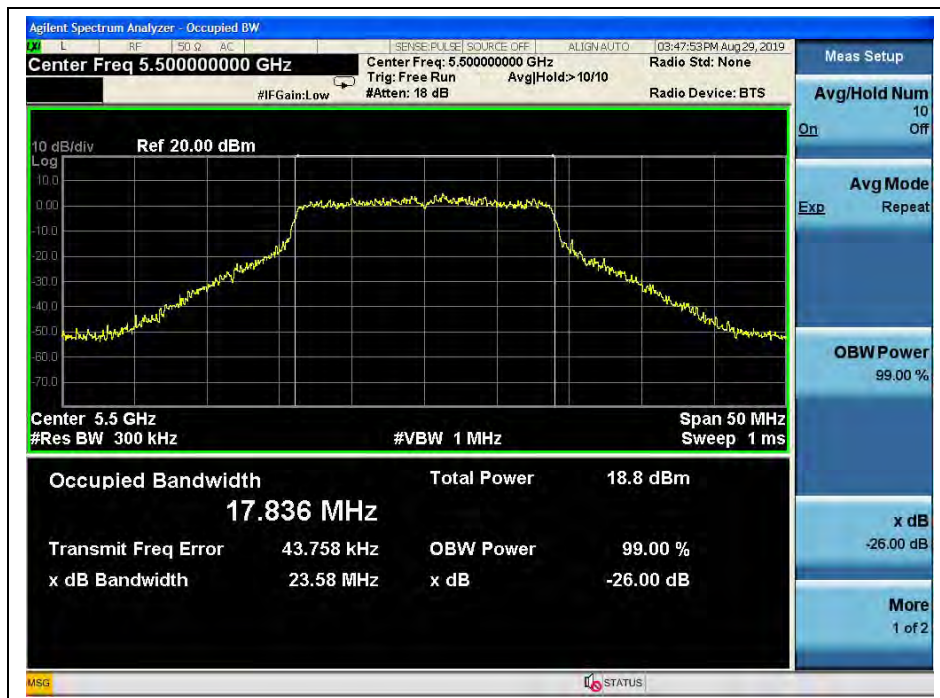
(Channel 100, 5500MHz, 802.11 ac (VHT20))
