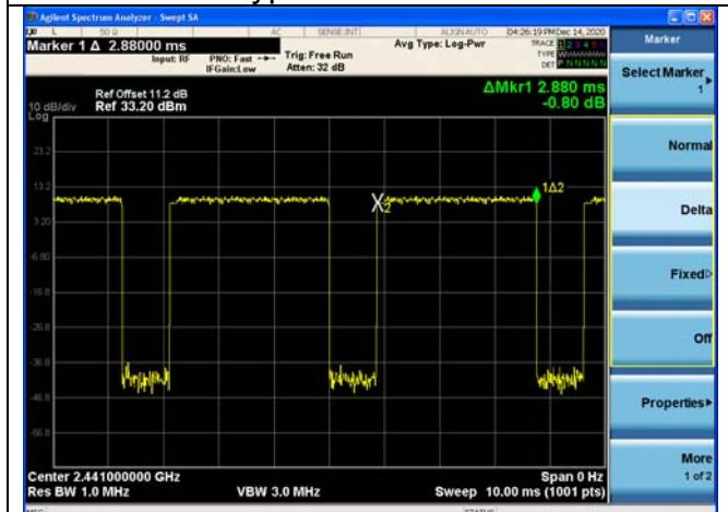
Modulation type: 8DPSK DH5 2441MHz
