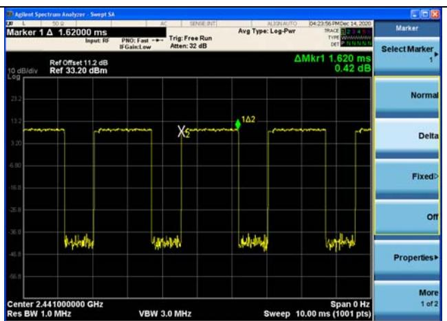
Modulation type:  $\pi/4$ DQPSK DH1 2441MHz
