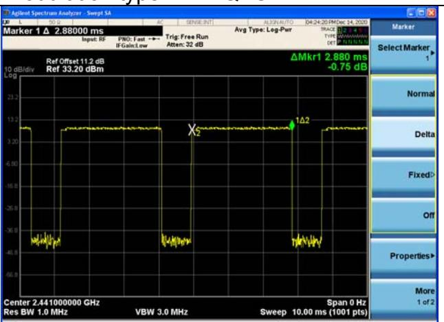
Modulation type:  $\pi/4$ DQPSK DH5 2441MHz
