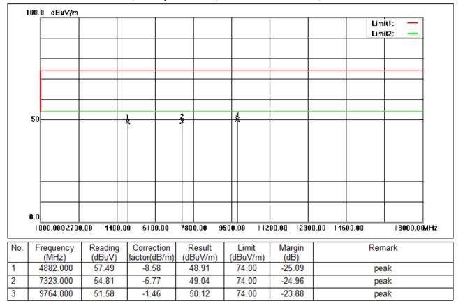
Test Mode: 01; Polarity: Horizontal; Modulation:π/4 DQPSK; Channel:middle
