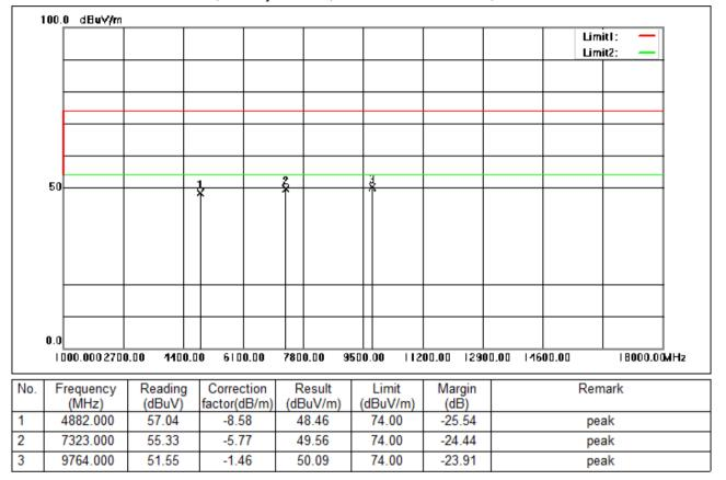
Test Mode: 01; Polarity: Vertical; Modulation:π/4 DQPSK; Channel:middle
