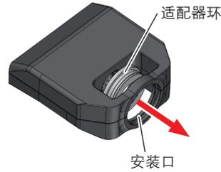
2. 从内部将转接环向安装口压，直到转接环啮合。
