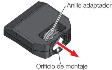
2. Presionar el anillo adaptador contra el orificio de montaje desde el interior hasta que encaje.
