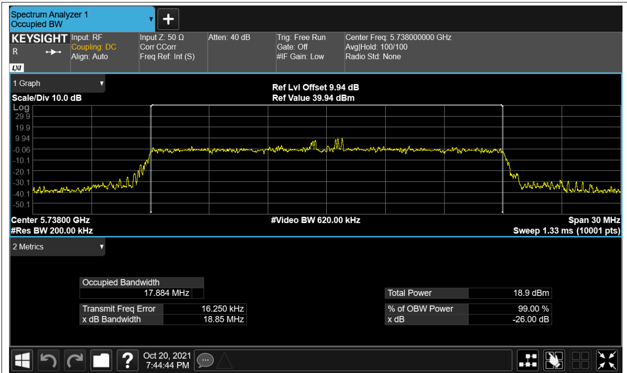
OBW HVHT 5.8G-20M-16QAM 5738MHz Ant2
