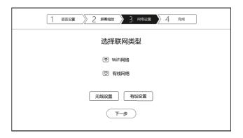
无线网络(WIFI):选择网络 SSID,输入密码,连接 WIFI 即可完成设置。 有线网络:无需其他操作,只需插入网线即可自动联网。网络设置完成后点 击下一步了解主界面功能即可完成整个设备的初始化。
