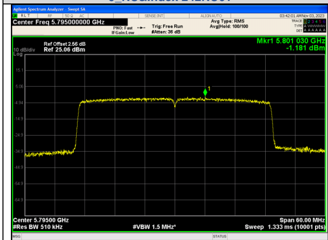
IEEE 802.11ax_Channel 159_40MHz_Antenna 0_RU&Index 484RU65
