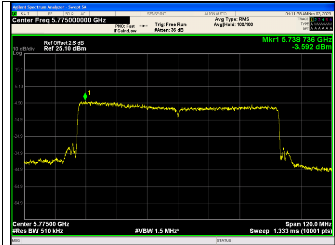
IEEE 802.11ax_Channel 155_80MHz_Antenna 0_RU&Index 996RU67
