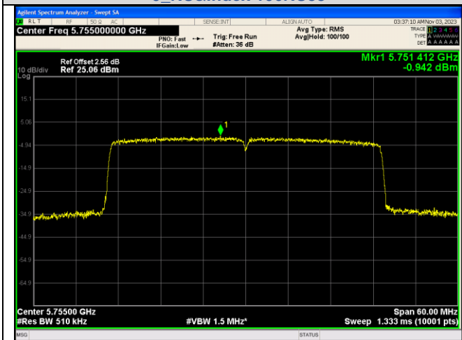
IEEE 802.11ax_Channel 151_40MHz_Antenna 0_RU&Index 484RU65
