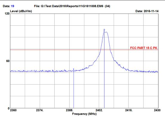
Site NO. : 3m Semi-Anechoic Chamber
