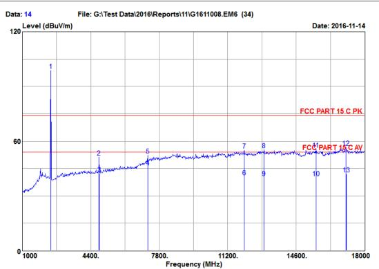
Site NO. : 3m Semi-Anechoic Chamber Dis. / Ant. : 3m 3115-62959-160620 Limit : FCC PART 15 C PK Env. / Ins. : 19.8\*C&58%/N9030A
