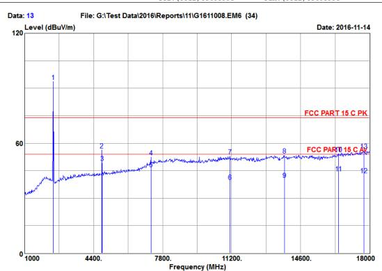
Site NO. : 3m Semi-Anechoic Chamber
