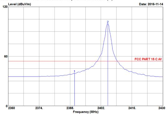
Site NO. : 3m Semi-Anechoic Chamber Dis. / Ant. : 3m 3115-62959-160620 Limit : FCC PART 15 C AV Env. / Ins. : 19.8\*C&58%/N9030A EUT : LED Lamp
