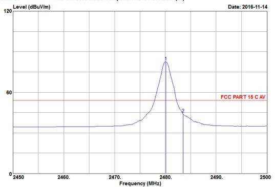
Site NO. : 3m Semi-Anechoic Chamber
