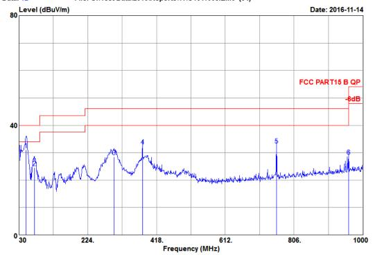
Site NO. : 3m chamber : 3m 6112D(22252)-1602 : FCC PART15 B QP : 19.8\*C&58%/ESCI Dis. / Ant. Limit Env. / Ins.
