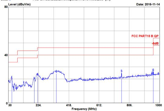
Site NO. : 3m chamber Dis. / Ant. Limit Env. / Ins. : 3m 6112D(22252)-1602 : FCC PART15 B QP
