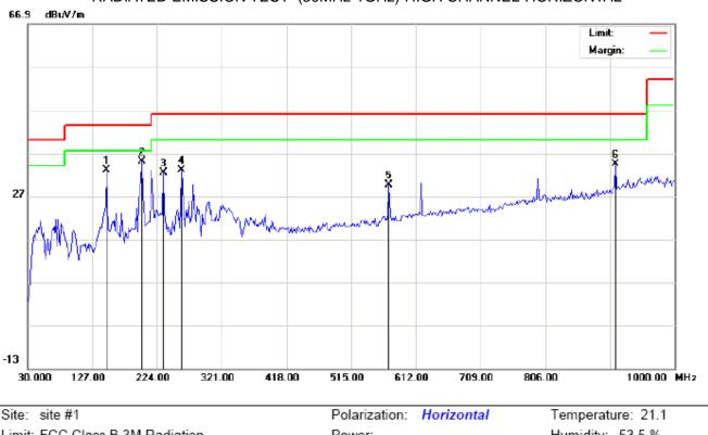
RADIATED EMISSION TEST- (30MHz-1GHz)-HIGH CHANNEL-HORIZONTAL
