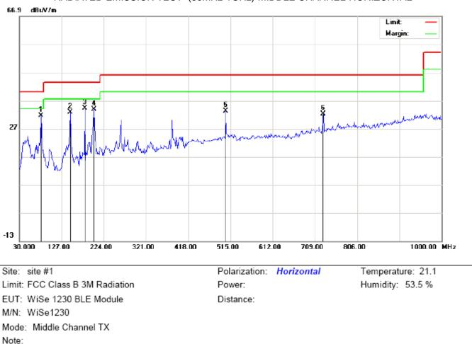
RADIATED EMISSION TEST- (30MHz-1GHz)-MIDDLE CHANNEL-HORIZONTAL
