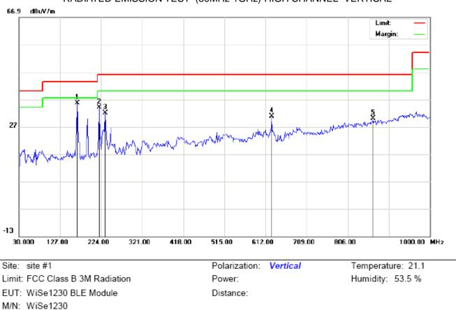
RADIATED EMISSION TEST- (30MHz-1GHz)-HIGH CHANNEL -VERTICAL
