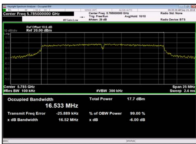
U-NII-3 6dB Bandwidth-802.11n(20MHz) ,5825MHz,Ant0
