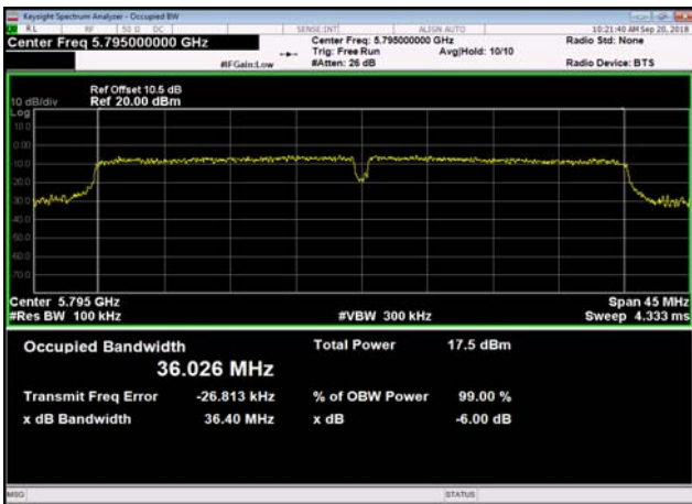
U-NII-3 6dB Bandwidth-802.11ac(80MHz) ,5775MHz,Ant0
