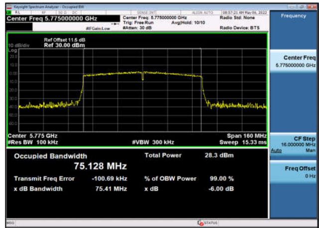
U-NII-3 6dB Bandwidth-802.11ax(20MHz) ,5785MHz,Ant0
