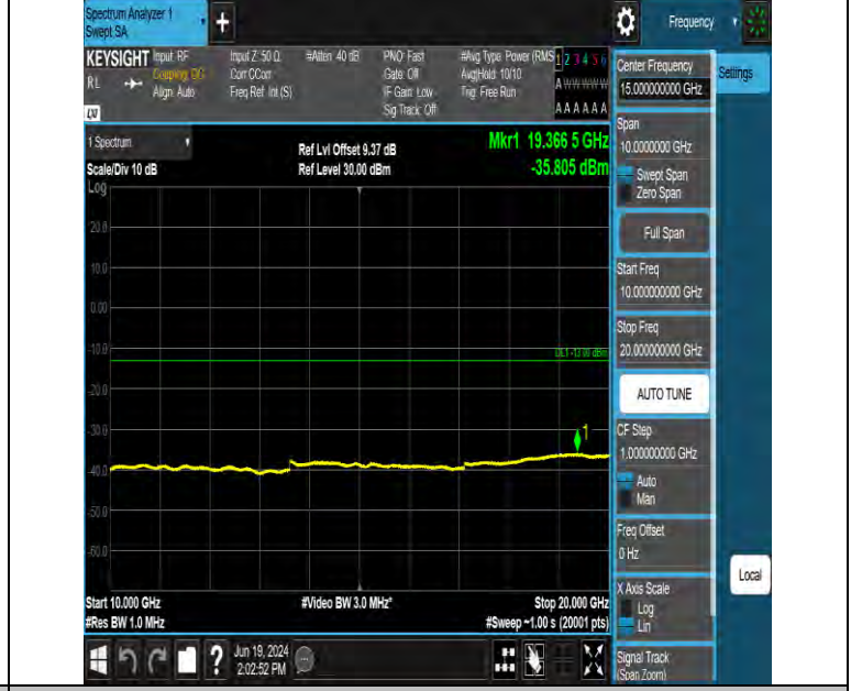
Band66 3MHz QPSK 131987 1RB#0 10000~20000 10000~20000
