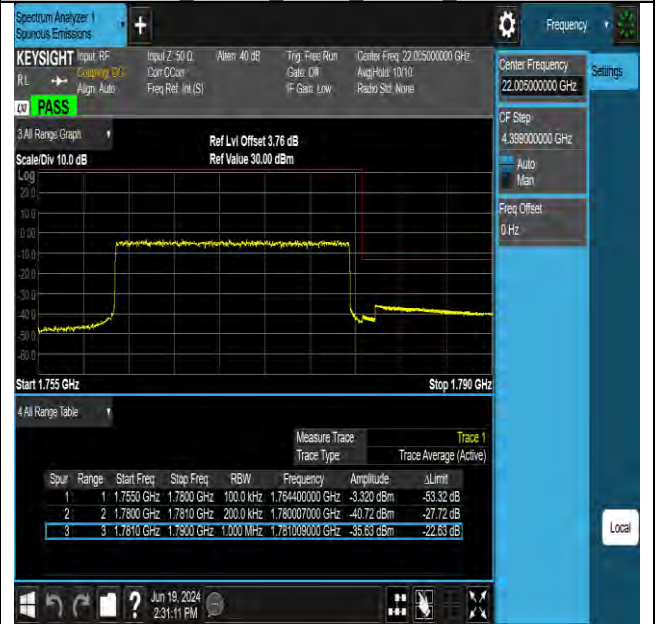
Band66 20MHz QPSK 132572 100RB#0
